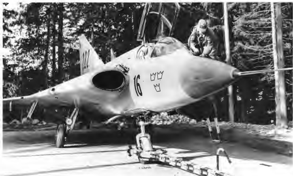
Ovan och nedan: J 35 Draken från F 16 respektive F 3 på krigsbas. Eftersom flygplanplatserna var utspridda långt från själva flygfältet bogserades flygplanen dit och därifrån. Här syns bogseringsbomen kopplad till främre hjulstället. Foton i Svensk Flyghistorisk Förenings arkiv.
