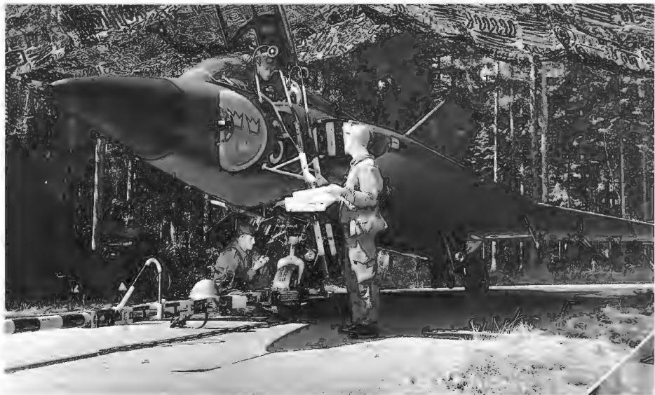
Ovan och nedan: J 35 Draken från F 16 respektive F 3 på krigsbas. Eftersom flygplanplatserna var utspridda långt från själva flygfältet bogserades flygplanen dit och därifrån. Här syns bogseringsbomen kopplad till främre hjulstället. Foton i Svensk Flyghistorisk Förenings arkiv.
